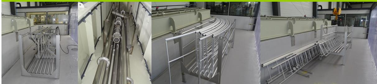
Toutes nos fabrications sont nettoyées et passivées dans les règles de l'art avant installation sur site
